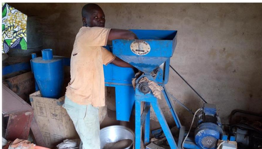
Poste de décortication sur le site de transformation de UFeDeB.
