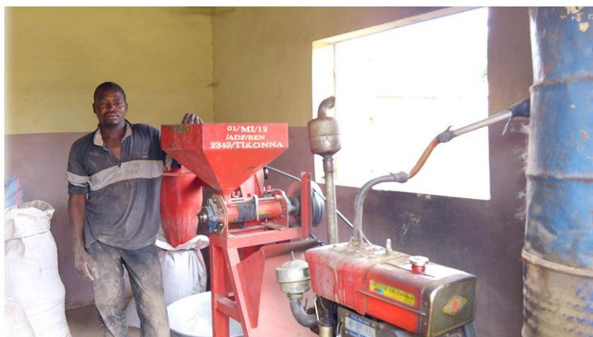
Poste de décortication sur le site de transformation de TIKONNA .
